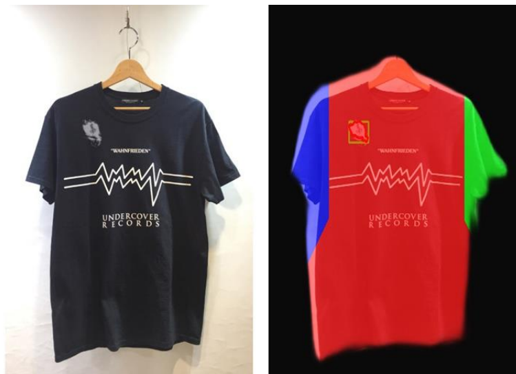
Abbildung 5: Das in PreQA entwickelte System zur Fehlererkennung nutzt Bildverarbeitung und KI um Fehler, wie etwa Flecken, automatisiert zu identifizieren und einzuordnen.
