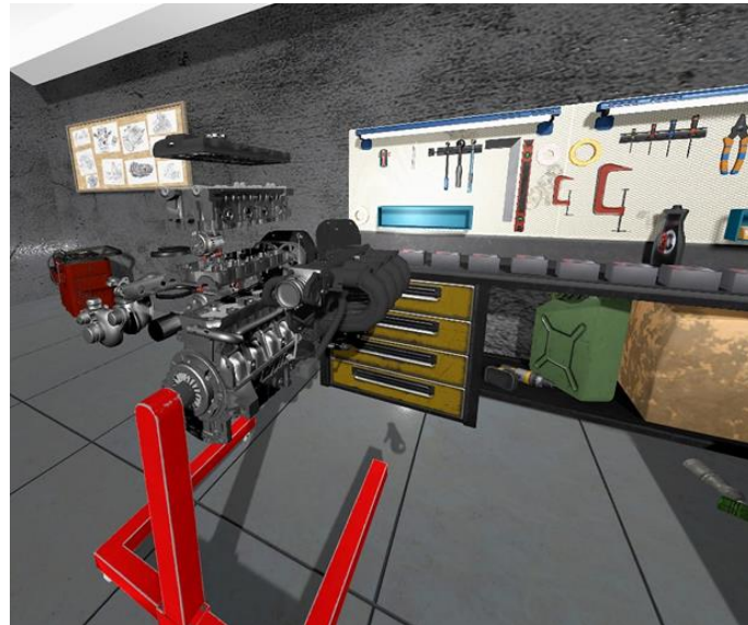
Abbildung 8: Die virtuelle Werkstatt - Das Bild zeigt einen Ausschnitt aus der vom AWSi entwickelten 3D-VR Umgebung. Zu sehen sind verschiedene Autoteile, die durch den Anwender interaktiv in der VR Umgebung zusammengebaut werden können.
