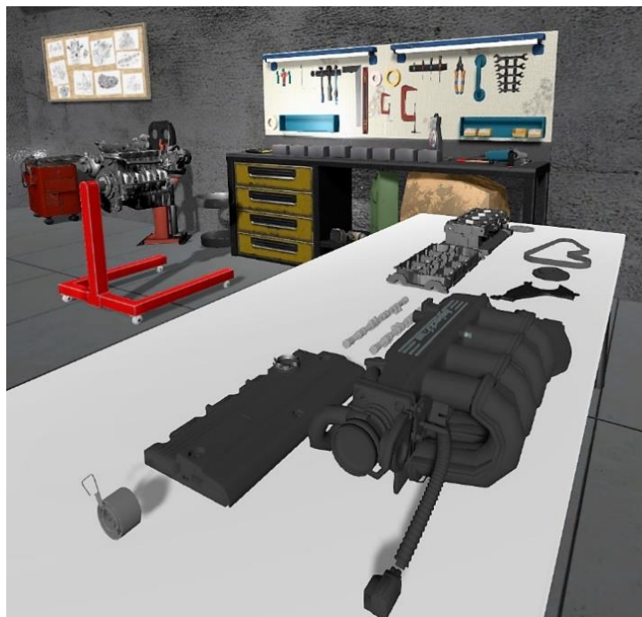
Abbildung 12: Die virtuelle Werkstatt – Das Bild zeigt einen Ausschnitt aus der vom AWSi entwickelten 3D-VR Umgebung. Zu sehen sind verschiedene Autoteile, die durch den Anwender interaktiv in der VR Umgebung zusammengebaut werden können.
