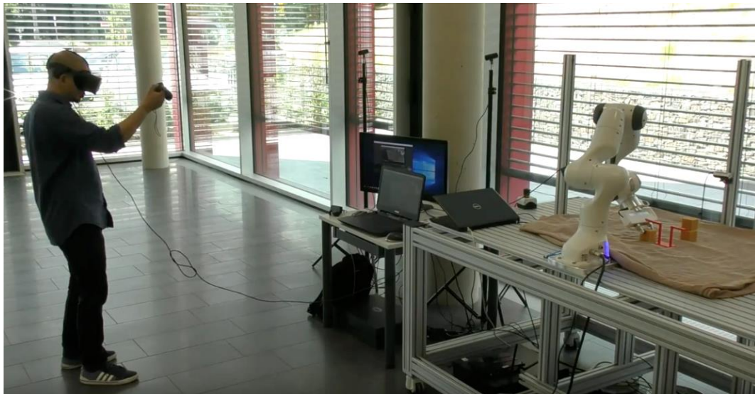
Abbildung 22: Masterand Akash Castelino bei der Bedienung der Teleoperationsschnittstelle zwischen VR-Anwendung und Roboterarm (links).
