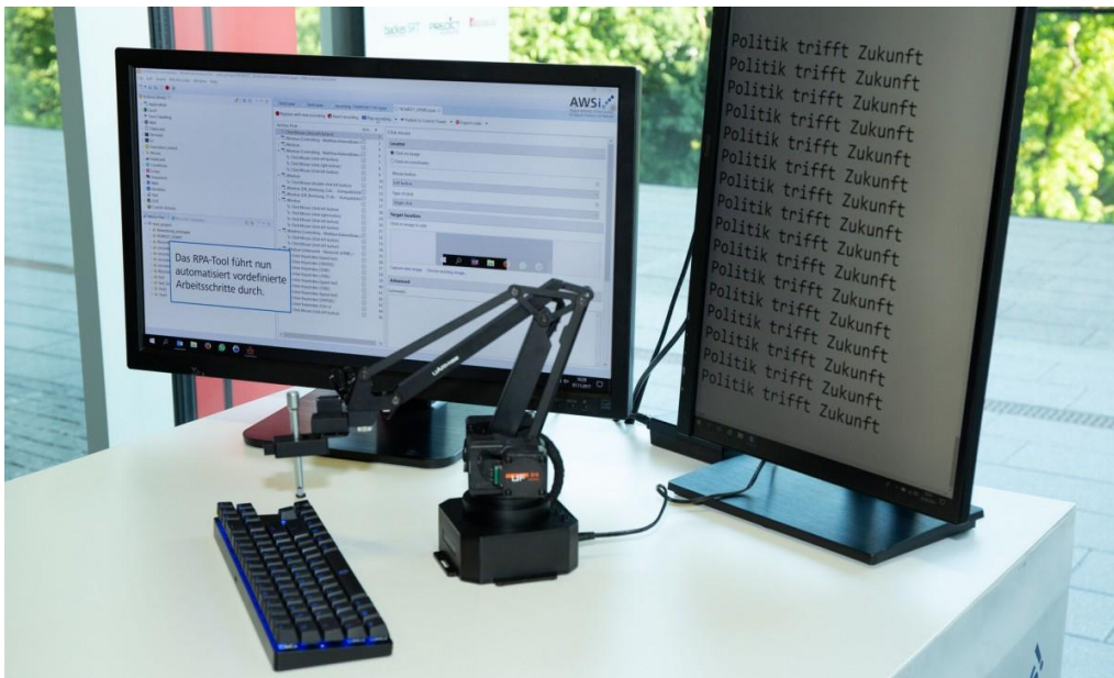
Abbildung 5: Der RPA-Demonstrator des AWSi zeigt anschaulich, wie Prozessautomatisierung durch Softwareroboter an einem Praxisbeispiel funktionieren kann.
