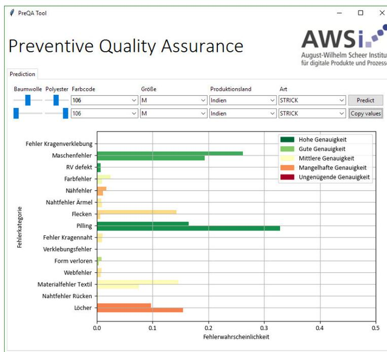
**Abbildung 9 Der PreQA-Demonstrator des AWSi. Strickware aus einem Baumwoll-Polyester-Mix erweist sich zwar als anfälliger für Maschenfehler, ist aber weniger anfällig für Pilling. Die Berechnung der gezeigten Vorhersage nimmt nur wenige Millisekunden in Anspruch**
