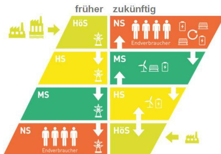
**Abbildung 8 Schematische Darstellung der Erzeuger und Verbraucherstruktur in den unterschiedlichen Stromnetzebenen im Vergleich früher und heute**
